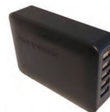
Chargeur multiple : 5 ports maximum Dimensions : 100*70*25 mm, 200 g Prises disponibles : EU, US, UK
