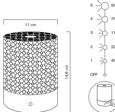
Lampe rechargeable avec interrupteur tactile
